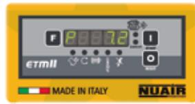
Il display del controller elettronico ETMII indica: pressione di esercizio, ore di lavoro/carico, stato carico/vuoto, temperatura olio.
